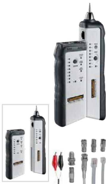
Set di rilevatori con trasmettitore e ricevitore per cavi LAN, SAT, TV, telefono e audio
