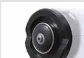
Misurazioni puntuali dello spessore del rivestimento tramite una piccola testa di misura
