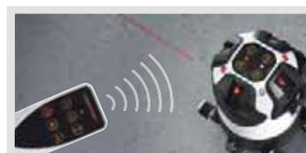
Tutte le linee laser e la funzione di inclinazione possono essere attivate/disattivate singolarmente con il telecomando.
