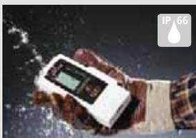
Gli strumenti di misura sono caratterizzati da una particolare protezione dalla polvere e dalla pioggia.
