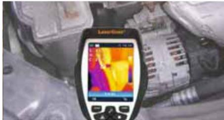
**Termocamera compatta per applicazioni nel settore edile, nell'elettronica e nell'industria meccanica**
